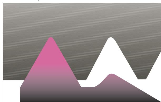
**Der V-Teilprofileinsatz schneidet, ohne die Außenseite des Gewindedurchmesser zu berühren. Der gleiche Einsatz kann für einen Bereich verwendet werden von verschiedenen Gewindesteigungen, die einen gemeinsamen Flankenwinkel haben.**
